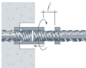
Le contre-écrou 2 étant toujours vissé à fond du filetage, il suffit de contrôler que la distance entre le coupleur et le contre-écrou 2 est comprise entre les valeurs suivantes:
