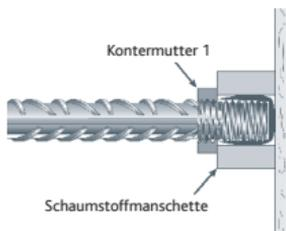
Der Gewindegusschutz und die Schaumstoffmanschette sind richtig positioniert.
