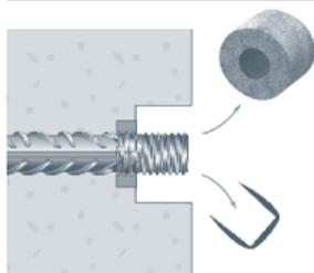
Aussparung freilegen und Schutz entfernen
