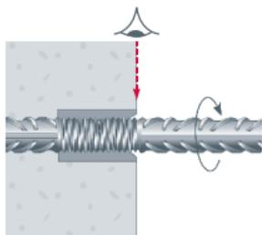
En fin de vissage aucune partie du filetage de la barre n'est visible à l'extérieur du coupleur.
