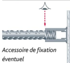
Aucune partie du filetage de la barre n'est visible à l'extérieur du coupleur.
