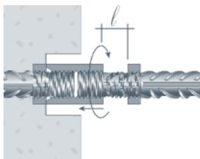
Wenn die Kontermutter 2 noch am Ende des Gewindes platziert ist genügt es, die Distanz zwischen der Muffe und der Kontermutter 2 zu kontrollieren. Sie muss zwischen den nachstehenden Werte liegen:
