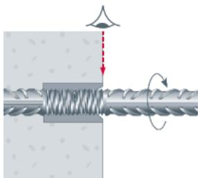
Nach dem Einschrauben ist das Gewinde nicht mehr sichtbar.
