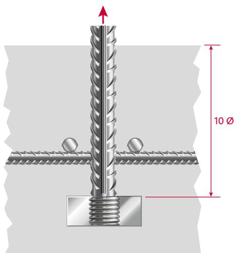
Longueur d'ancrage minimale =  $10 \varnothing$
