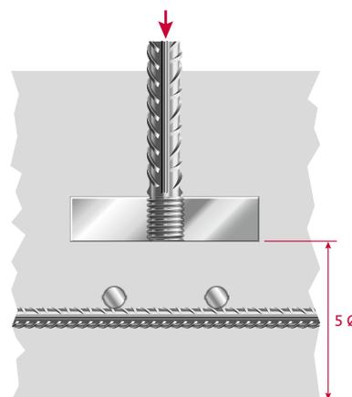
Il faut tenir compte des tractions transversales locales dans la zone d'ancrage et prévoir une armature adéquate.
