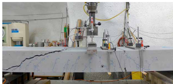
Die hohe Querkraftübertragung von 85 % wurde versuchstechnisch nachgewiesen.
