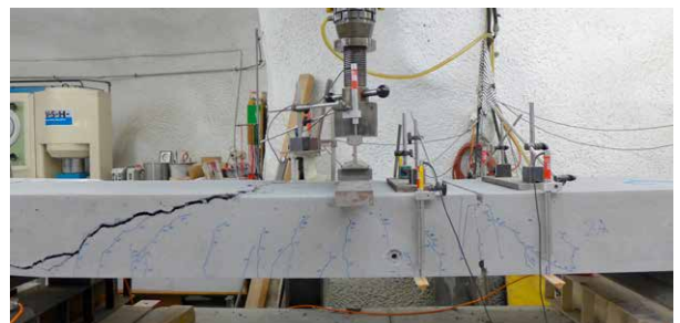
Die hohe Querkraftübertragung von 85 % wurde versuchstechnisch nachgewiesen.
