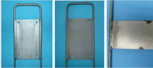
Abb. 3: Halbfabrikate, links gebeizt, Mitte gestrahlt, rechts lokal gebeizt mit Einbränden
