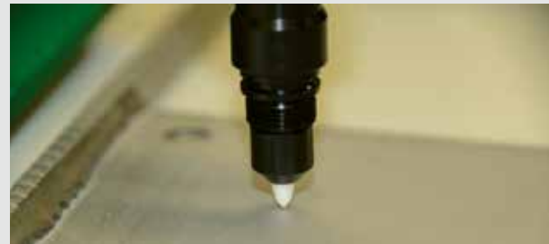
Abb. 1: Auf der Stahloberfläche aufgesetzte EC-Pen Messspitze
