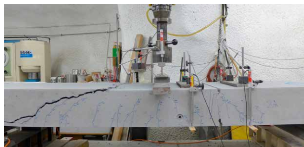
Les essais confirment la haute reprise des forces de cisaillement (85 %).
