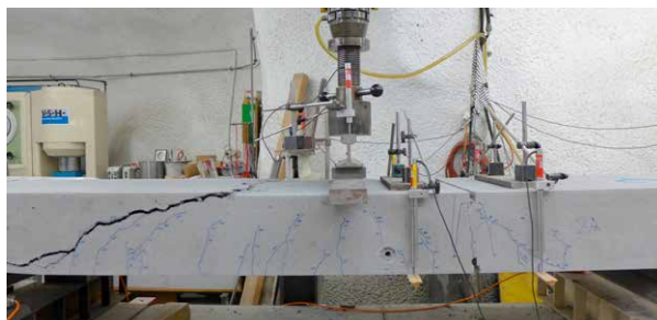
Die hohe Querkraftübertragung von 85 % wurde versuchstechnisch nachgewiesen.
