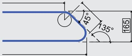
Die Längenangaben sind Aussenmasse in cm. Die Masse auf 1 cm gerundet anzugeben. Sofern bei geschlossenen Bügeln die Biegelänge weniger als 21 cm beträgt, wird die Figur nach Aufwand, im Minimum nach BG S verrechnet.
