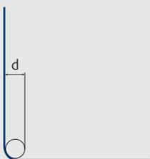
Biegerolledurchmesser d2 und d3 nur angeben, wenn zwingend ein Biegerolledurchmesser gefordert wird. Biegerolledurchmesser werden in (mm) angegeben.
