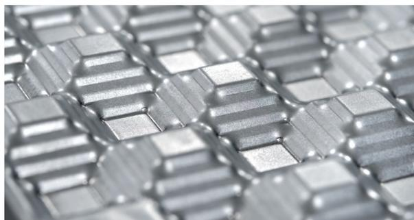
*La structure pyramidale en damier permet une reprise maximale des forces de cisaillement dans toutes les directions.*
