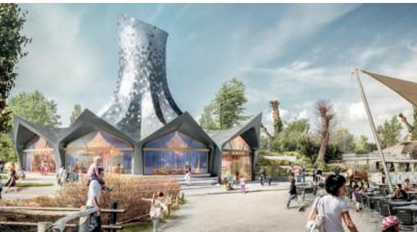
**Le toit du nouvel espace polyvalent du zoo pour enfants Knie de Rapperswil évoque un chapeau de magicien. Sa charpente en bois repose sur une fondation dodécagonale en béton armé. Les barres de cet anneau de traction qui absorbe les forces d'écartement de l'énorme toit sont raccordées par des liaisons BARTEC® LER de Debrunner Acifer.**
