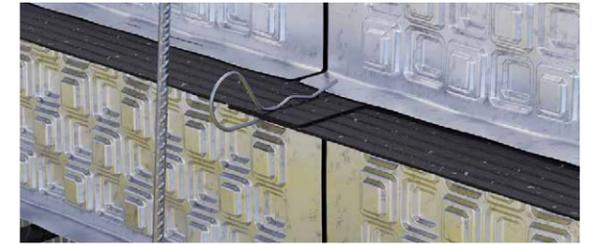
Abb. 8: Verbindungsstoss beim PYRAPAN PW+
