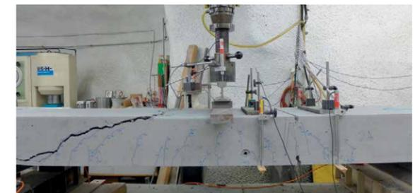
Die hohe Querkraftübertragung von 85 % wurde versuchstechnisch nachgewiesen.
