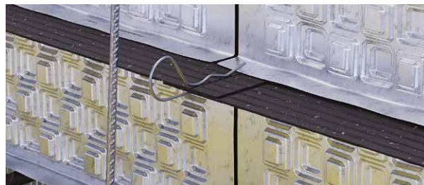
Abb. 8: Verbindungsstoss beim PYRAPAN PW+
