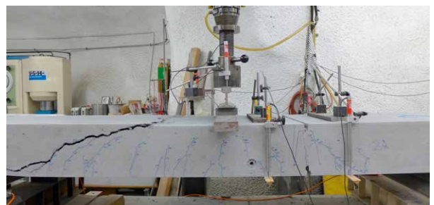
Die hohe Querkraftübertragung von 85 % wurde versuchstechnisch nachgewiesen.
